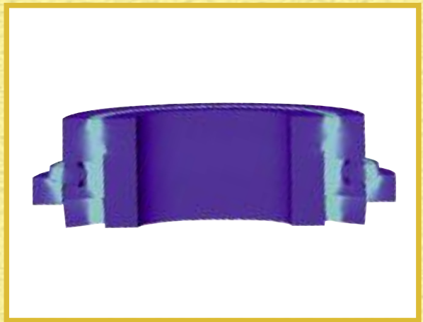
4 Static nodal stress with thrust washer 有推力垫圈的静态节点应力
