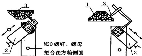
图 12 砂轮修整装置
